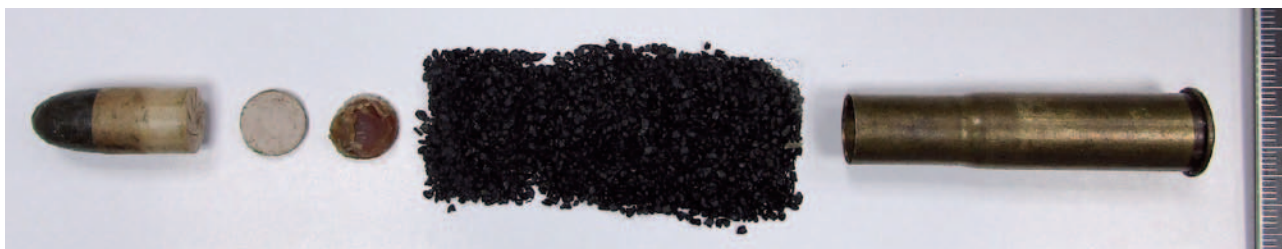
Ryc. 3. Rozcalony nabój karabinowy kal. 11 mm × 60R Mauser z 1878 r.: pocisk z owijką papierową, przybitka kartonowa, przybitka woskowa wraz z kartonową (dolną), proch strzelniczy czarny (dymny), łuska.
