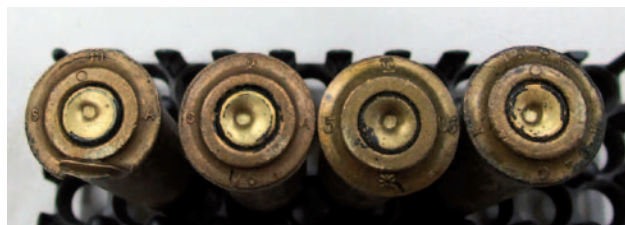
Ryc. 5. Dna łusek pochodzących od naboji karabinowych kal. 11 mm × 60R Mauser odstrzelonych w toku prób sprawnościowych broni. Widoczne ślady grota iglicznego oraz oznaczenia producenta.
