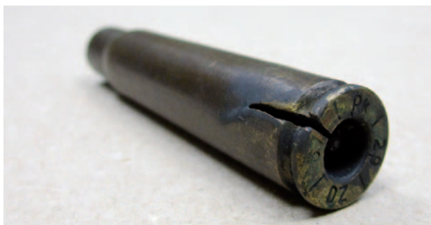
Ryc. 7. Uszkodzenia łuski od odstrzelonego naboju karabinowego kal. 7,92 × 57 mm Mauser z 1929 r. produkcji polskiej.
