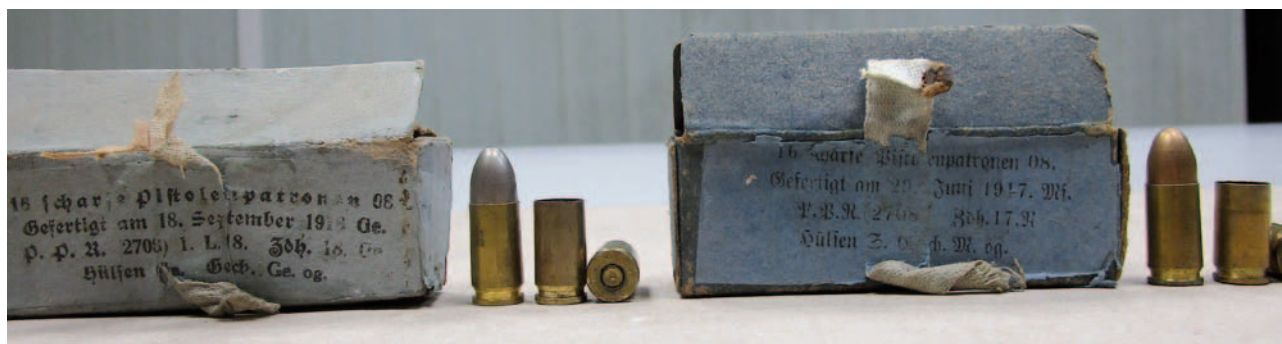
Ryc. 1. Dostarczone do badañ naboje pistoletowe kal. 9 × 19 mm Parabellum z 1917 r. i 1918 r. oraz łuski od odstrzelonych dowodowych naboí wraz z opakowaniami amunicyjnymi. Płaszczki pocisków naboí z opakowania z 18 września 1918 r. były platerowane melchiorem, natomiast pozostałe naboje miały pociski o płaszczech stalowych platerowanych tombakiem.
