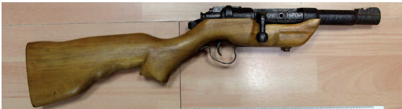
Ryc. 2. Poddany badaniom karabin jednostrzałowy Mauser wz. 1871 r. kal. 11 mm b/n produkcji niemieckiej w stanie dostarczonym do badań, tzw. obrzyn.
