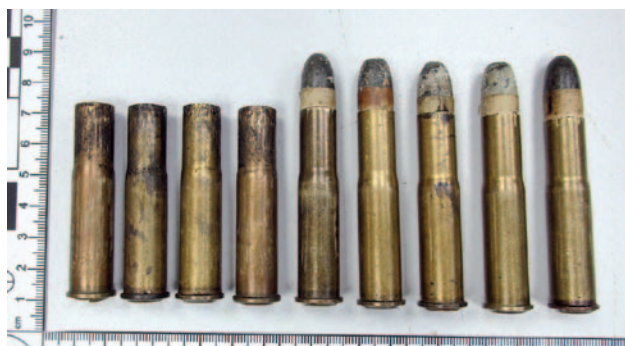
Ryc. 4. Naboje karabinowe kal. 11 mm × 60R Mauser oraz łuski od takich naboji odstrzelonych z badanego karabinu Mauser wz. 1871 kal. 11 mm b/n produkcji niemieckiej.
