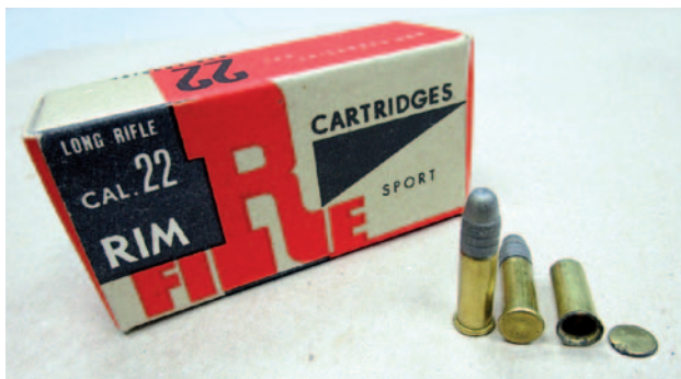
Ryc. 6. „Naboje boczno zapłonu zwykłe SPORT” z lat siedemdziesiątych będące obecnie przyczyną niebezpiecznych rozerwań łusek podczas strzału. Obok naboju leżąca rozerwana łuska w postaci korpusu oraz oderwanego dna. W tle opakowanie amunicyjne.
