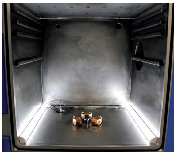
Ryc. 6. Wnętrze komory do metalizacji próżniowej VMD360.
