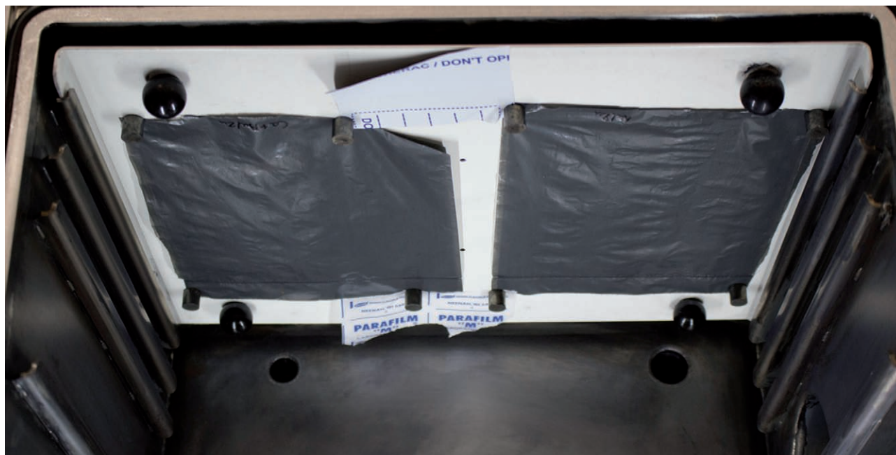
Ryc. 7. Sposób umieszczania przedmiotów w komorze w trakcie procesu ujawniania – powierzchnie poddawane procesowi ujawniania przytwierdza się za pomocą magnesów w górnej części komory VMD360 na specjalnym uchwycie.
