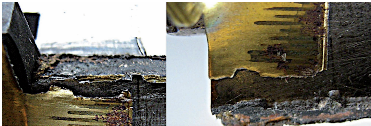
Ryc. 4. Widok złożonych krawędzi rozerwanej komory nabojevej i łuski.
