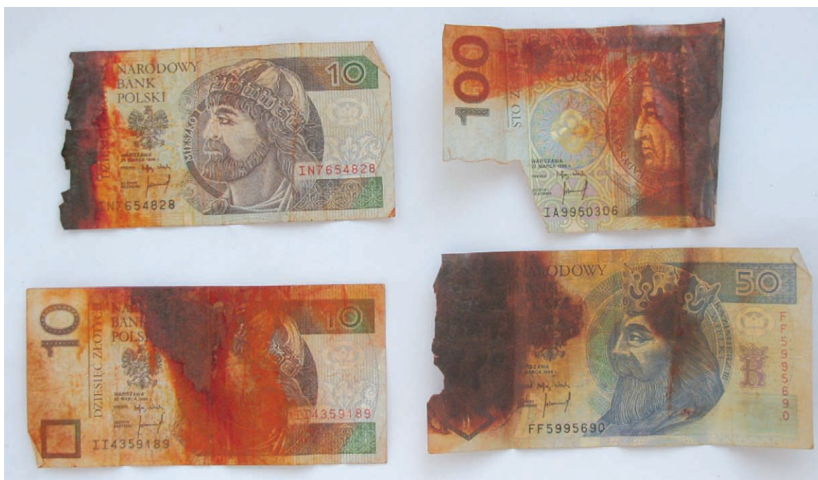
Ryc. 15. Banknoty zniszczone generatorem dymu urządzenia zabezpieczającego przed kradzieżą (barwnik – chinizaryna).
