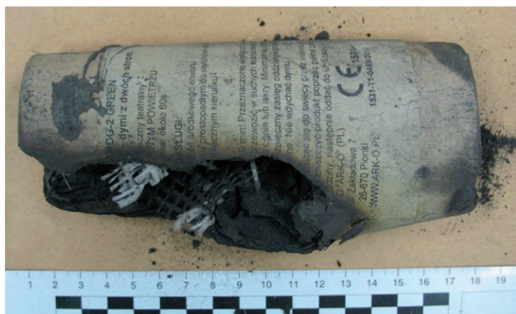
Ryc. 2. Pozostałości wypalonego generatora zielonego dymu.
