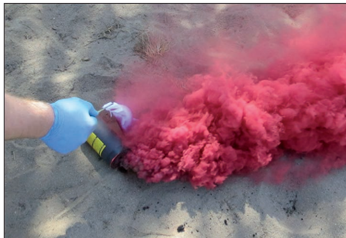
Ryc. 7. Pobieranie próbki do badań ze strumienia dymu.
