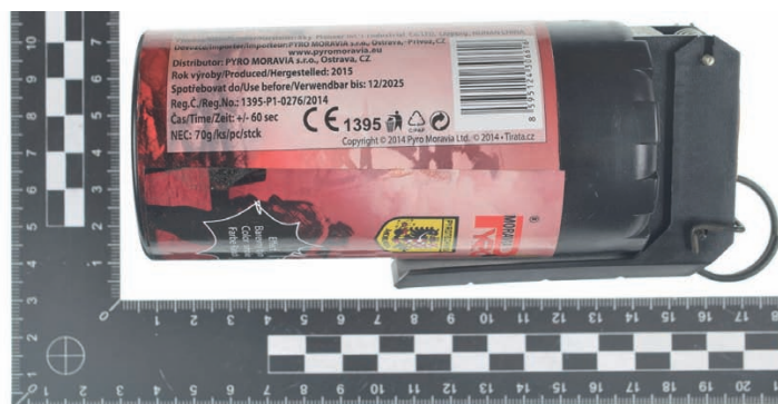
Ryc. 6. Generator dymu z tarciovym systemem odpalania i dźwignią spustową.
