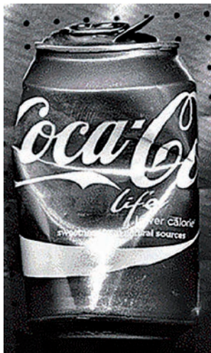
Ryc. 18, 19. Puszka ze śladami linii papilarnych ujawnionymi proszkiem Magnetic Fluor Red.
