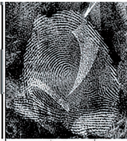
Ryc. 20, 21. Ślady linii papilarnych ujawnione na puszcze i zeskanowane systemem TrasoScan przy oświetleniu 365 nm i zastosowaniu żółtego filtra oględzinowego.
