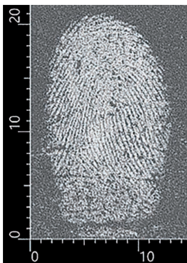
Ryc. 14. Negatywowy obraz śladu zabezpieczonego w kurzu i zeskanowanego systemem TrasoScan.
