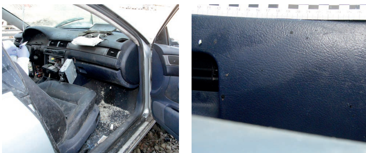
Ryc. 8. Wnętrze badanego samochodu AUDI A6 oraz zbliżenie na przetarcia znajdujące się na powierzchni drzwiczek przedniego schowka
