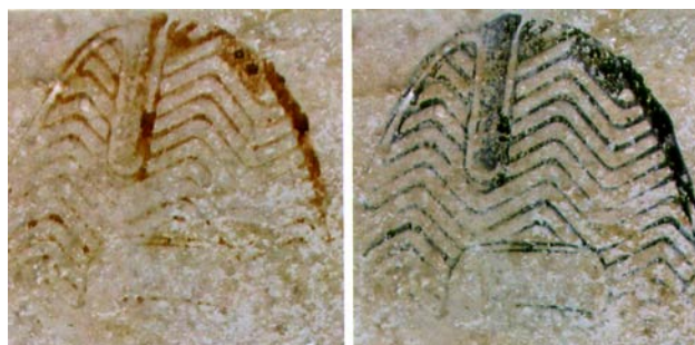
Ryc. 23, 24. Ślad krwawy na podłożu niechłonnym przed (po lewej) i po ujawnieniu czernią amidową (po prawej)
