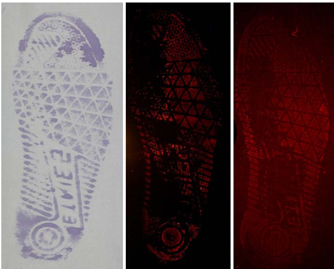
Ryc. 26, 27, 28. Ślad krwawy ujawniony LCV widoczny w świetle białym (po lewej), we fluorescencji (w środku) oraz we fluorescencji, gdy źródłem światła jest laser (po prawej)
