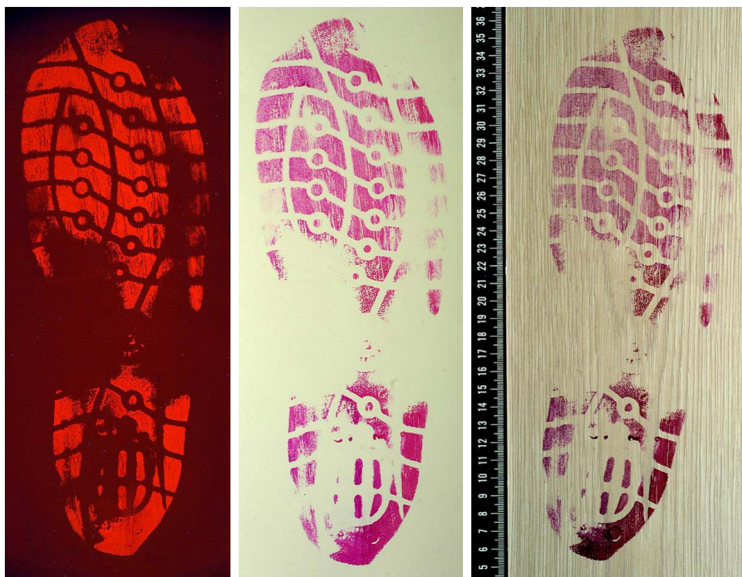
Ryc. 17, 18, 19. Ślad krwawy ujawniony czerwinią węgierską widoczny w świetle białym na podłożu (po lewej) oraz po przeniesieniu z podłoża na białą folię żelatynową widoczny w świetle białym (w środku) i we fluorescencji (po prawej)
