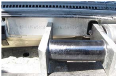
Ryc. 4, 5. Badanie pola numerowego pojazdu z wykorzystaniem defektoskopu stałomagnetycznego
