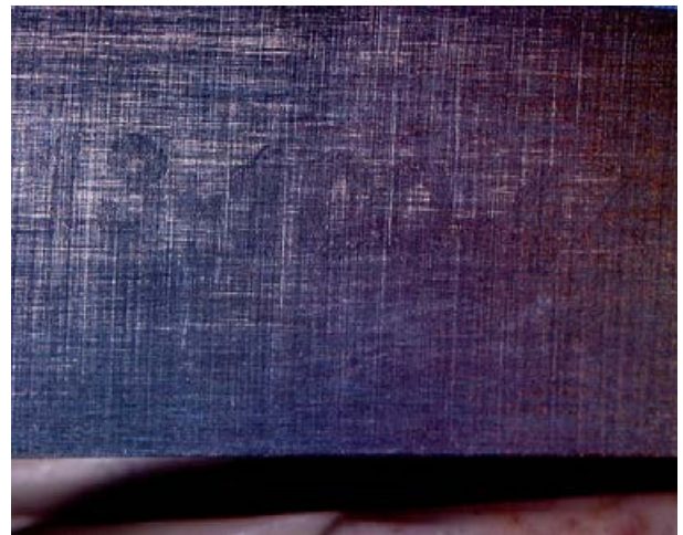
Ryc. 13. Oznaczenie numerów narzędzi chirurgicznych odtworzone odczynnikami chemicznymi
