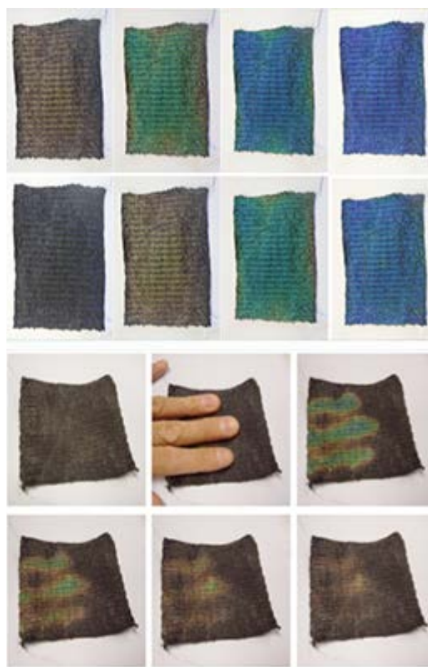
Ryc. 10. Fabcell – tkanina elektrochromowa
