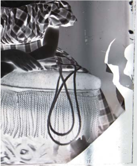
Il. 11. Niedolany narożnik negatywu (miejsce, w którym fotograf trzymał płytkę szklaną podczas wylewania kolodionu). Widoczne także uszkodzenia warstwy fotograficznej (pęknięcie nitrocelulozy wraz z jej zawinięciem)
