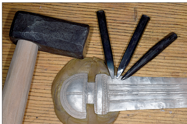
Ryc. 20. Zdobienie repliki główki bransolety osadzonej na masie repuserskiej (młotek i punce do ornamentu perlowanego, liniowego, oraz punktak do wykonania zygzaka – rekonstrukcja). Bez skali. Wykonanie i fot.: J. Strobin
