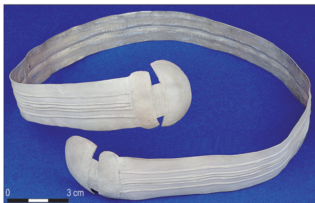
Ryc. 17. Bransoleta po odkuciu na foremniku kabłąka i repusowaniu główek – rekonstrukcja. Wykonanie i fot.: J. Strobin
