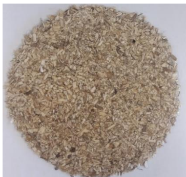
Rys. 5. Kompozyt otrzymany w wyniku prasowania. Fig. 5. Composite obtained as a result of pressing.
