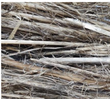
Rys. 1. Paździerze konopne – wypełnienie kompozytu.
