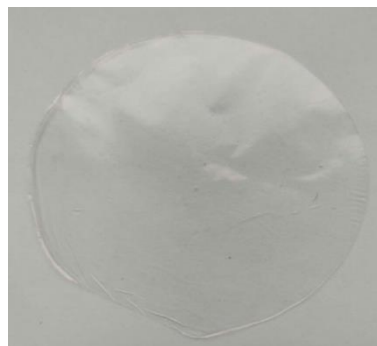
Rys. 2. Krążek wykonany z PLA – matryca kompozytu.
