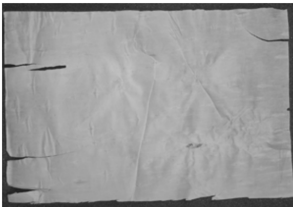
4. List z 1947 r. Brak śladów pisma w świetle IR wskazuje na nieobecność sadzy w badanym atramencie, fot. Michał Obarzanowski
