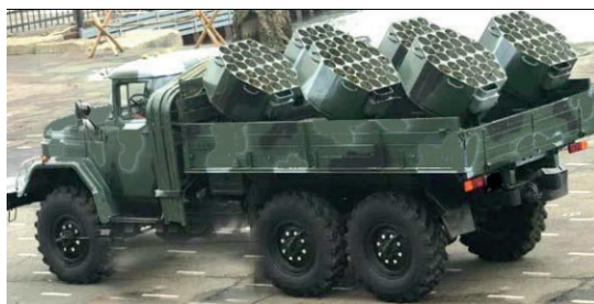
Rysunek 15. Naziemny system minowania narzutowego UMZ na pojeździe ZIL-131W 15 Źródło: K. Wysocki, M. Depczyński, P. Szymczak, Współczesne wojska inżynieryjne... , op. cit., s. 144.
