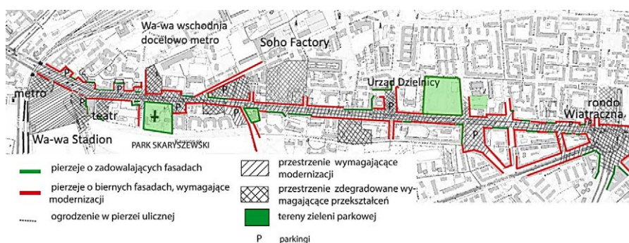
Ryc. 8. Ulica Grochowska – inwentaryzacja fasad i przestrzeni wymagających modernizacji
