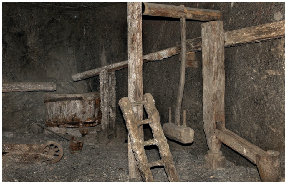
Fot. 4. Pompa wahadłowa – urządzenie do transportu solanki stosowane w czasach J. G. Borlacha
