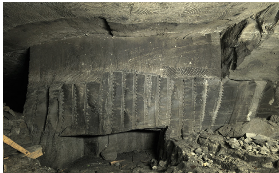
11. Komora Ksawer Górny. Ocios i strop chodnika rozcinającego pokład soli spizowej. Czola wrębów i negatywy klinów żelaznych odrywających kłapeć (fot. K. Kozłowski)
