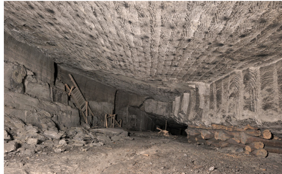
13. Komora Leopold Górny. Faktura stropu i ociosów po eksploatacji ręcznej (fot. K. Kozłowski) 13. The Leopold Górny chamber. Texture of the roof and sidewalls after manual mining works (photograph by K. Kozłowski)
