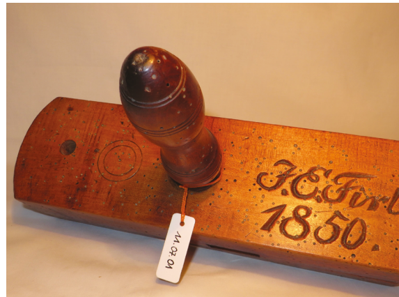
15. Narzynka do wycinania gwintu śrub drewnianych, Polska, Wrocław, 1850 – wyrób rzemieślniczy, J.E. Firil; w otworze śruba wzorcowa z toczonym uchwytem – narzędzie służące do wykonywania śrub imadeł stołów stolarskich oraz różnego rodzaju ścisków i pras; do wykonania gwintowanego otworu służyły stalowe gwintowniki, tworzące z narzynkami pary o tej samej średnicy i skoku gwintu
