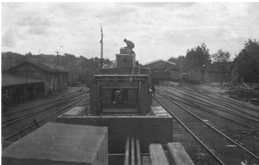
Wagon artyleryjski pociągu „Śmiały-Szeroki”, doskonale widoczne dodane betonowe „opancerzenie” wagonu. Zdjęcie wykonane z lory przewożącej materiały do naprawy torów (podkłady, szyny, narzędzia) pchanej przed wagonem artyleryjskim dla zabezpieczenia przed wybuchem miny. Źródło: zbiory własne autora.
