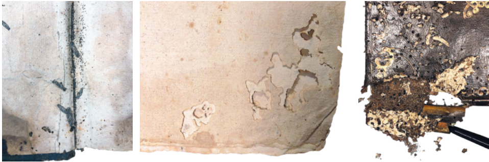
Il. 4-6. Ubytki papieru i zniszczenia okładki wraz ze skórzaną oprawą spowodowane długookresowym żerowaniem owadów. Dokument znajduje się w Archiwum Księży Zmartwychwstańców w Rzymie.
