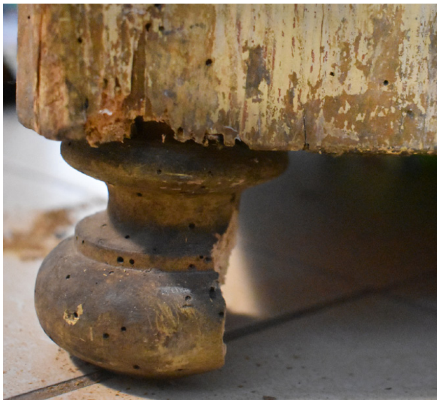
Fot. 3. Fragment komody z pozostałością jednej z dwóch toczonych nóg: widoczne ślady znacznego żerowania owadzych szkodników drewna
