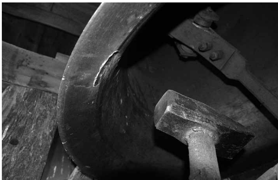
Cybinka (powiat słubicki) – przykład, jak można zniszczyć niemal nowy (zaledwie 100-letni!) brązowy dzwon, niewłaściwie montując napęd
