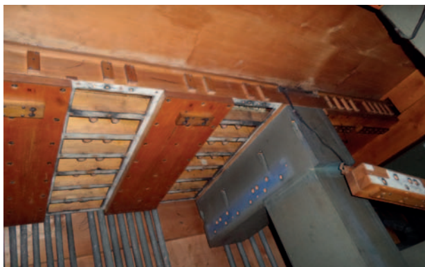
Il. 12. Częściowo otwarte wiałownice upustowe - przed remontem (foto „Organistrzostwo Kamerton – Wiesław Jeleń”, 2015).
