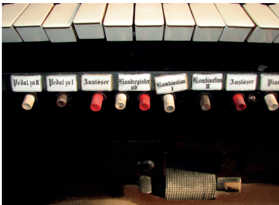
Włączniki kopulacji, wolnych i stałych kombinacji, watek crescendo – fot. autor
