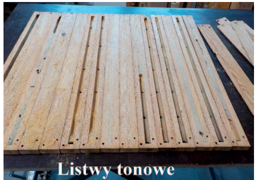
Zniszczenia listw tonowych – fot. A. Sutowicz
