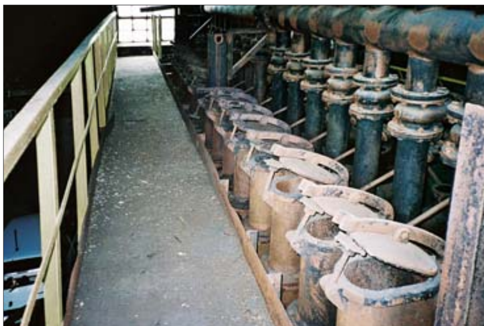
14. Piece retortowe w gazowni w Śmiglu. Takie piece znajdowały się w większości małych gazowni, 2004 r. Fot. T. Palacz.
