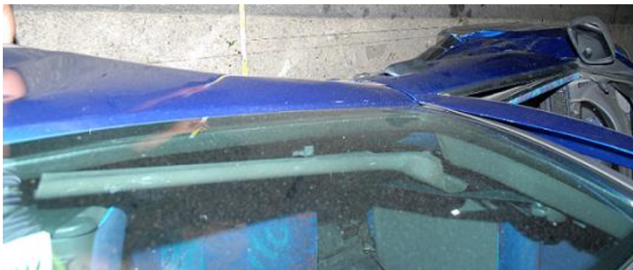
Ryc. 5. Pomiar głębokości deformacji lewej strony nadwozia Fiata Punto, ich głębokość wynosiła ok. 0,26 m.
