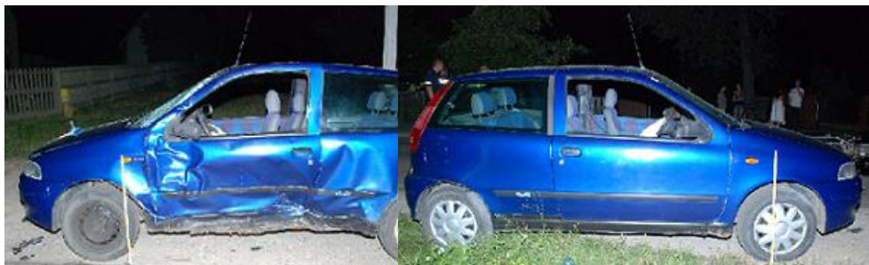
Ryc. 3,4. Zestaw zdjęć prezentujący uszkodzenia nadwozia samochodu osobowego Fiat Punto i jego pozycję powypadkową
