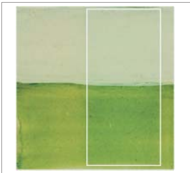
1. Akwarelowe warstwy malarskie poddane przyspieszonemu starzeniu pod wpływem światła. Błękit pruski z żółcią kadmową w pełnym tonie i w rozbiele (w ramce – pole starzone). Wszystkie fot. E. Szmít-Naud.
