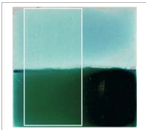
5. Akwarelowe warstwy malarskie poddane przyspieszonemu starzeniu pod wpływem światła. Błękit pruski z zielenią szmaragdową w pełnym tonie i w rozbiale (w ramce – pole starzone).
