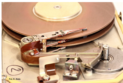
II. 9. Mechanizm twardego dysku. Fot. K. Ziolo, 2019 r.
