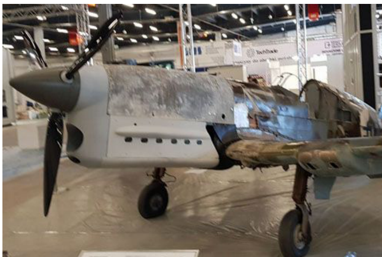
Rysunek 5. Francuski samolot myśliwski Caudron CR-714 Cyclone z dorobionymi technologią wielkoformatowego druku 3D pełnym okapotowaniem silnika, przednim wlotem do chłodnicy oraz kołpakiem z trójłopatowym śmigłem (Zdjęcie: Jakub Link-Lenczowski via [8])
