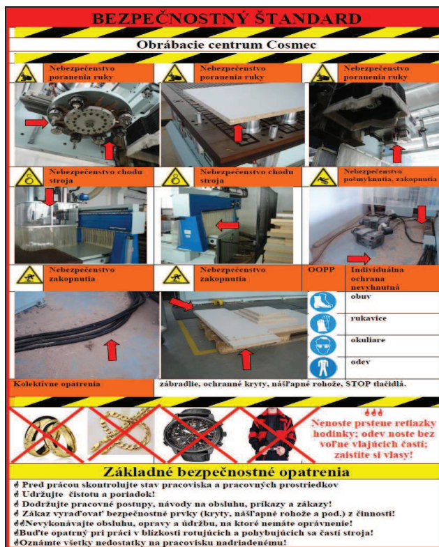
Obrázok 2. Bezpečnostný štandard pre obrábacie centrum Cosmec
