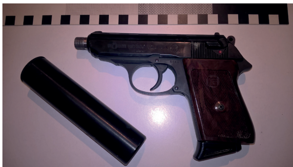
Ryc. 1. Przerobiony samodziółowo pistolet gazowy RÖHM mod. RG 800 kal. 8 mm z tłumikiem.
