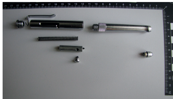
Ryc. 3. Rozłożony „długopis strzelający”.
