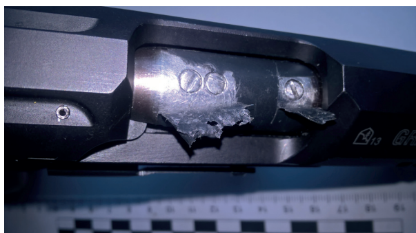
Ryc. 5. Widok zaślepionych wkrętami otworów w ścianie lufy.
