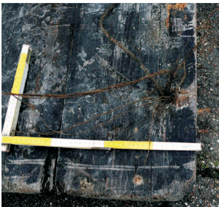
Ryc. 5. Widok na otwór w górnej klepce zewnętrznej części płetwy sterowej z zachowanym fragmentem sznura. Na górnej powierzchni obecne gwoździe, prawdopodobnie mocujące skrzynię z dociążeniem steru, fot. A. Ostasz Fig. 5. A view of the hole in the top plank of the outer part of the rudder's fin with a preserved fragment of a rope. On upper surface there are nails, presumably for fixing a box with rudder ballast, photo A. Ostasz
