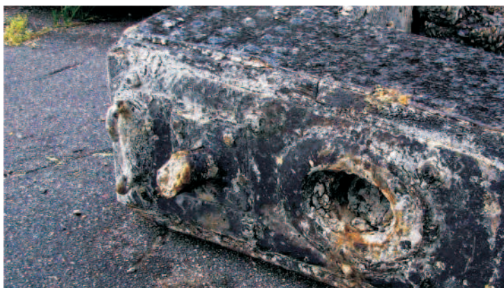
Ryc. 4. Widok na górne okucie sterownicy z pozostałością po flagsztoku i półkluźą. Wewnątrz otworu widoczne przesunięcie okucia względem samego otworu, fot. A. Ostasz Fig. 4. A view of the upper mount of the tiller with rests of the ensign stick and the fairlead. Inside the hole, the mount shift in respect of the hole itself is visible, photo A. Ostasz
