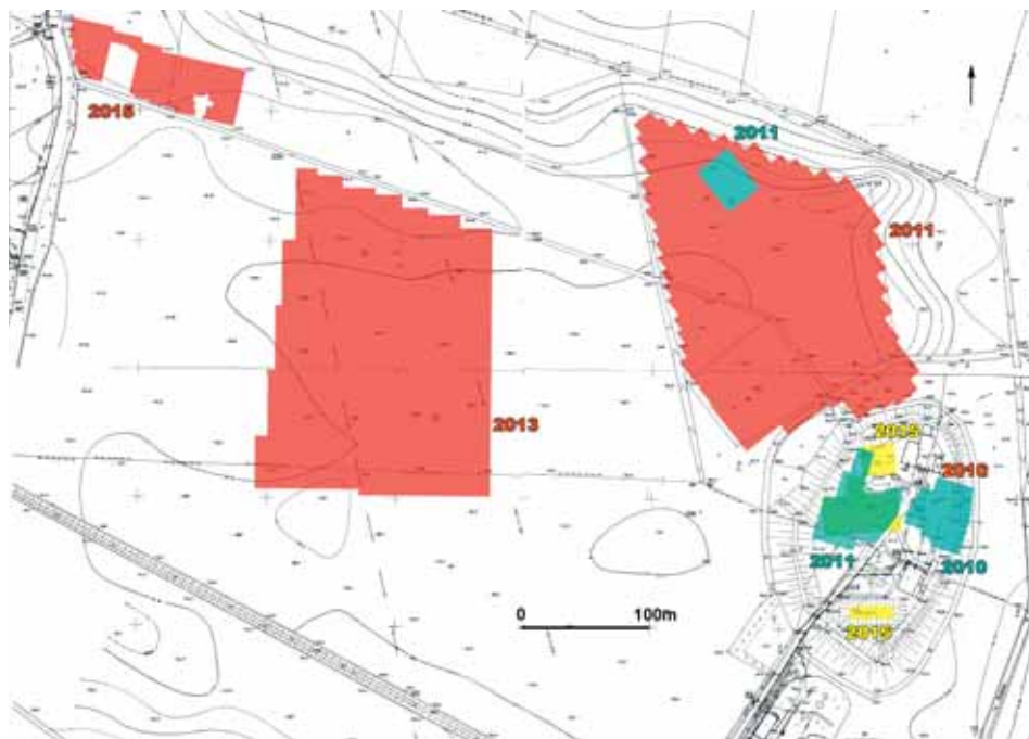
OBR. 11. Giecz dz. ewid. 31/2, 33/1, 33/2, 156/1, 158, 160/1, 160/2, 162, 163, 164/1, 165/3, 169, gm. Dominowo, pow. średzki. Vymezení sledovaných ploch geofyzikálním průzkumem na výřezu mapového podkladu lokality (červeně – magnetometrie, azurově – odporové měření, žlutě – profilová měření radarem). Zdroj MPP na Lednicy, Rezerwat Archeologiczny Gród w Gieczu
