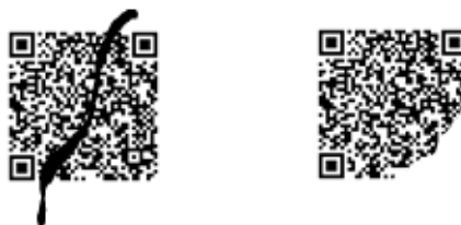
Rys. 2. Przykłady uszkodzonych kodów QR, które mogą zostać poprawnie odczytane Źródło: Ibid.
