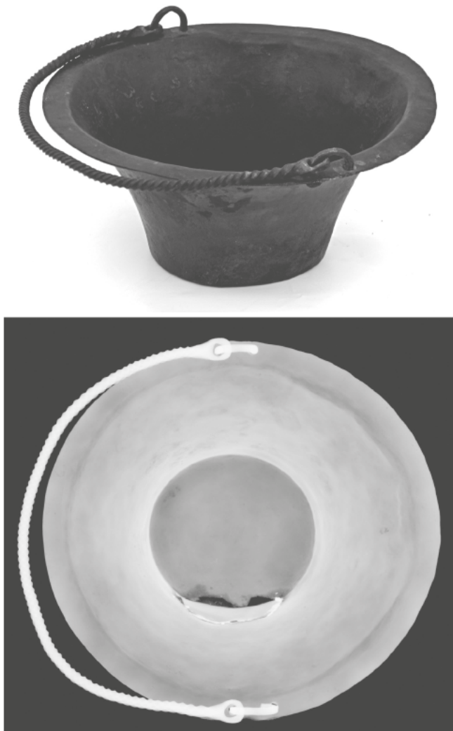
Obr. 4 Nádoba z Gízy (ĀMUL 2169) na digitální fotografii a snímku z radiografie (foto J. Kmošek, rentgenový snímek J. Kmošek, A. König) / Fig. 4 A vessel from Giza (ĀMUL 2169), photograph and X-ray image (photo J. Kmošek, X-ray image J. Kmošek, A. König)
