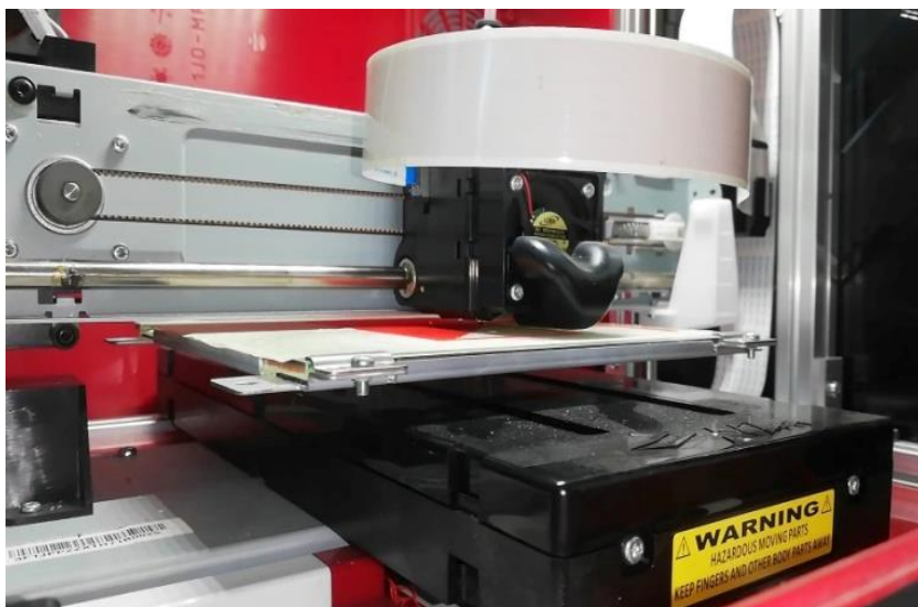
Rys. 2. Drukarka 3D da Vinci Junior podczas drukowania obudowy dla nakładki LCD 1602 KEYPAD
