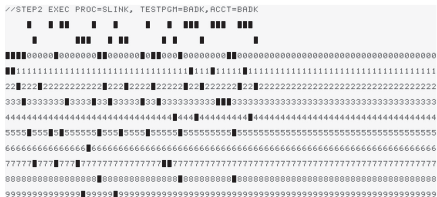
Rys. 1. Karta perforowana typu 5081
