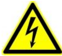
Obr. 5. Nebezpečenstvo úrazu elektrinou
