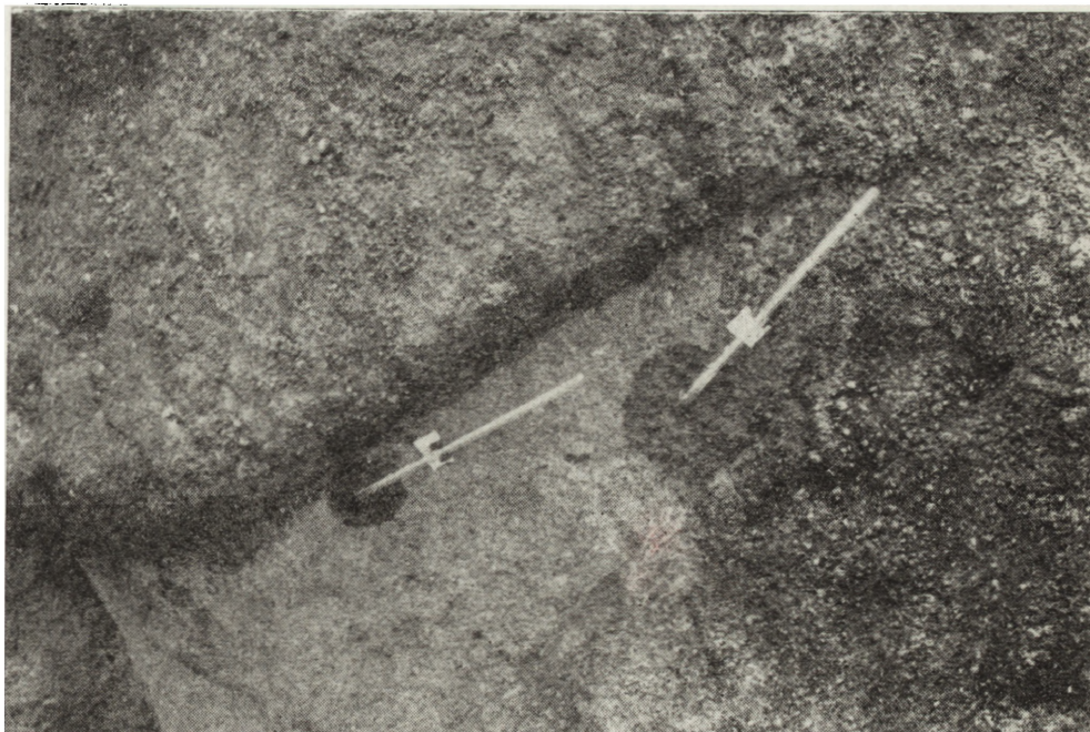
12. Pomiarzy zdolności kapilarnego wnikania cieczy w pory kamienia prowadzone na szyi rzeźby pokrytej nawarstwieniami opalowymi (mała plama) oraz na partii o zniszczonej powierzchni
