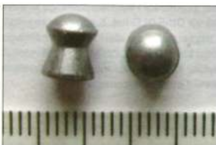
Ryc. 12. Widok części bocznej i wierzchołkowej pocisku DIABOLO kal. 5,5 mm (wierzchołek zaokrąglony) Fig. 12. Side and top view of DIABOLO cal. 5.5 bullet (round-point)
