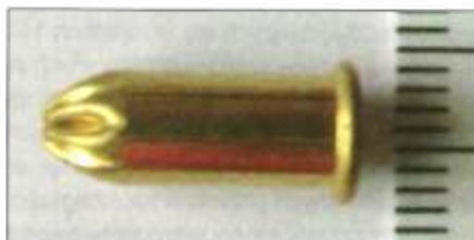
Ryc. 11. Widok naboju alarmowego bocznego zapłonu kal. 5,6 mm (.22) long Fig. 11. View of Signac cartridge of cal. 22 long rifle rimfire
