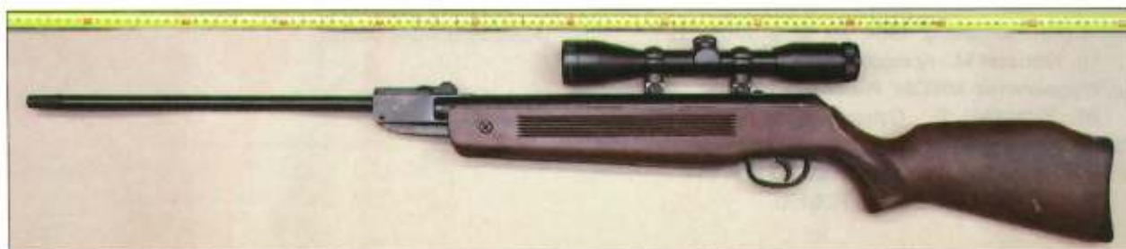
Ryc. 1. Widok lewej strony karabinka kal. 5,6 mm (.22) wykonanego samodziłowo na bazie karabinka pneumatycznego HATSAN mod. 60 kal. 5,5 mm Fig. 1. Left side of cal. 22 home-made shotgun based on HATSAN model 60 cal. 5.5 mm air shotgun Źródło (ryc. 1–13): autorzy
