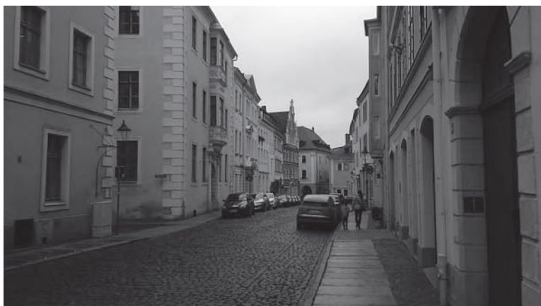
Fot. 7. Goerlitz – zespół staromiejski z oryginalną nawierzchnią ulic z XIX wieku (jasne płyty granitowe i czarna kostka bazaltowa) poddaną renowacji i przełożeniu w trakcie ostatnich prac renowacyjnych. Fot. S. Wróblewski 2015.
