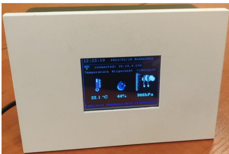
Rys. 3. Stacja pogodowa zaprojektowana w pracy
