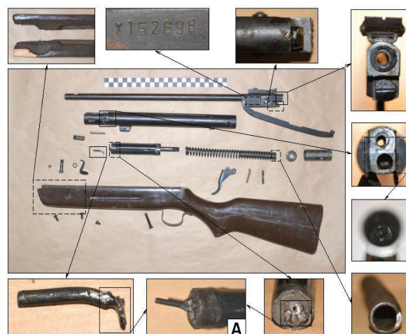
Ryc. 7. Przykład konstrukcji przerobionej broni pneumatycznej: rozwiercony kanał wylotowy sprężonego powietrza, do tłoka sprężania dospawany cienki pręt metalowy pełniący rolę iglicy (A).
