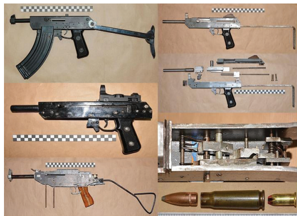
Ryc. 6. Pistolety maszynowe wytworzone samodzielnie (jeden po rozłożeniu z widocznymi szczegółami budowy mechanizmu) i amunicja produkcji samodzielnej.
