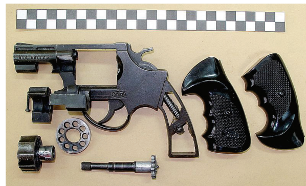
Ryc. 10. Przykład konstrukcji przerobionego rewolweru alarmowego: przegroda lufy została usunięta, natomiast ślepą część bębna naboju odcięto z jednoczesnym dołączeniem krążka z sześcioma otworami.
