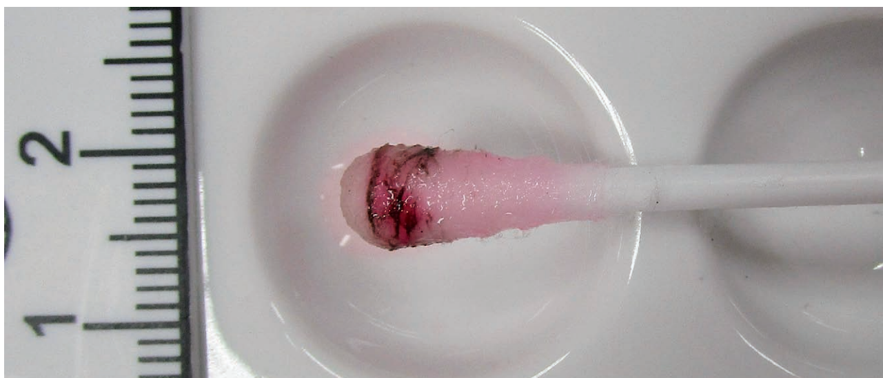
Ryc. 4. Wyraźna reakcja barwna jednoskładnikowego odczynnika Griessa na osad usunięty z przewodu lufy pistoletu Astra kal. 5,6 mm produkcji hiszpańskiej po 6 latach od oddania strzałów.
