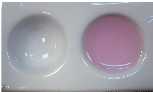
Ryc. 5. Zabarwienie wodnego roztworu osadu z lufy barwnikiem daktyloskopijnym Basic Red.
