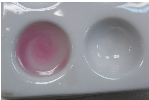
Ryc. 2. Reakcja barwna na osad zebrany z przewodu lufy pistoletu Glock 30 kal. 11,43 mm (.45 ACP) prod. austriackiej po upływie 2 miesięcy (zestaw POCH-TEST PIR-S).
