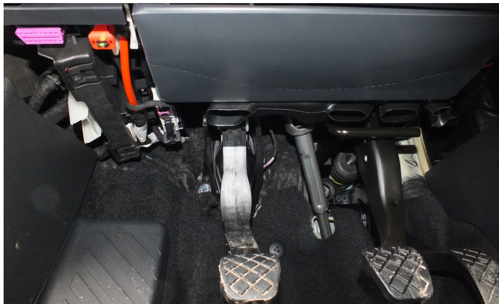
Ryc. 4. Umieszczenie gniazda OBD II w nowych samochodach
