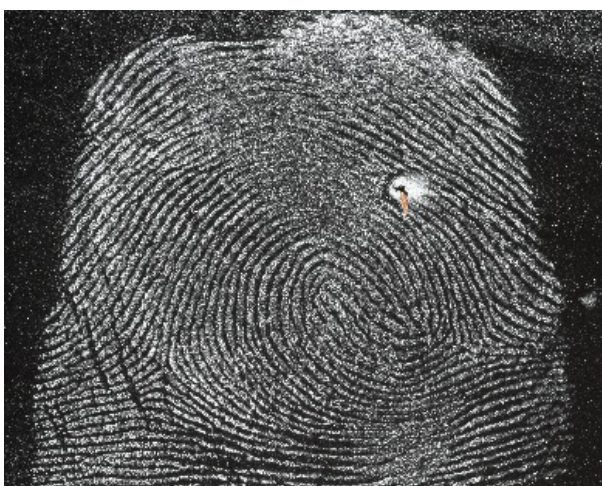
Ryc. 31. Ślad linii papilarnych ujawniony na płytce ceramicznej zawieszoną NANODAK 40, zarejestrowany w świetle białym
