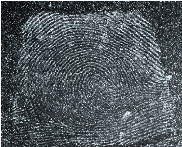
Ryc. 21. Ślad linii papilarnych ujawniony na płytce ceramicznej zawiesiną NANODAK 30, zarejestrowany w świetle białym
