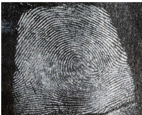
Ryc. 42. Ślad linii papilarnych ujawniony na folii aluminiowej nanoproszkiem NANODAK 1, zarejestrowany w świetle białym
