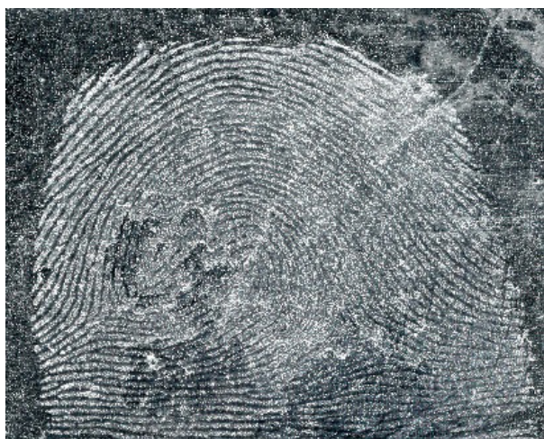
Ryc. 36. Ślad linii papilarnych ujawniony na folii aluminiowej zawieszoną NANODAK 40, zarejestrowany w świetle białym
