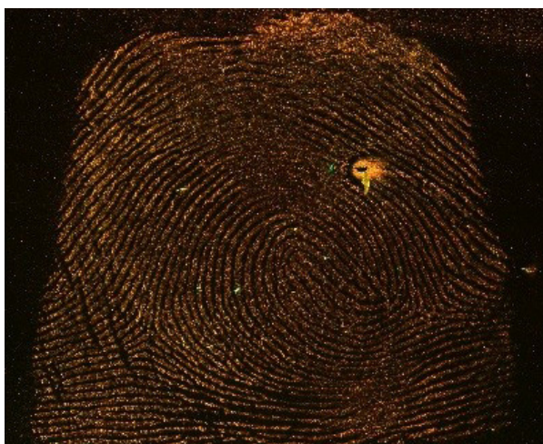
Ryc. 33. Ślad linii papilarnych ujawniony na płytce ceramicznej zawieszoną NANODAK 40, zarejestrowany w świetle UV o długości fali 360 nm, z żółtym filtrem
